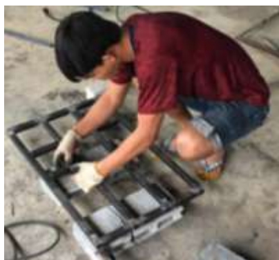
ภาพที่ 4.30 ประกอบโครงเหล็ก
